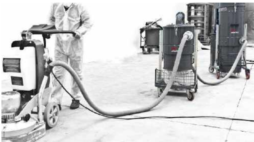
Separatori mobili con scarico Longopac per trattamento superfici | Separators with Longopac discharge system for floor preparation
