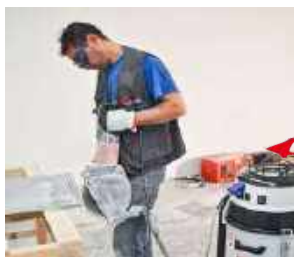
Attacco per elettro utensili da 600 Watt Power tool electric socket, max 600 Watt
