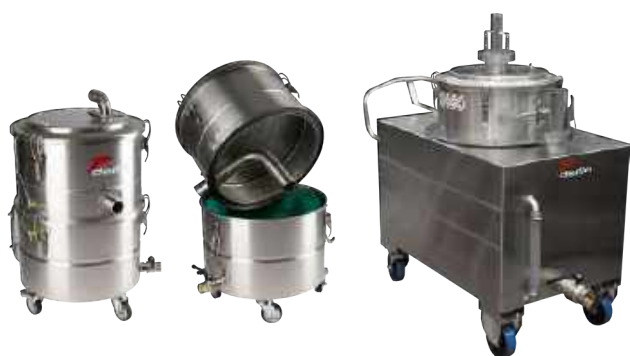
Separatori per il recupero di polveri infiammabili o esplosive Separators for the collection of explosive or flammable dust
